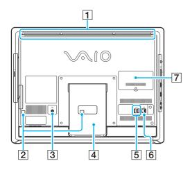
Wenn der Computer in Betrieb ist, wird der Bereich um die Belüftungsöffnung (1) heiß. Warten Sie ab, bis der Computer entsprechend abgekühlt ist, bevor Sie diesen Bereich berühren.
