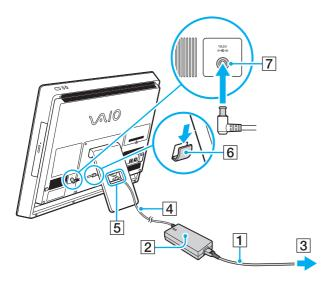
Die Form des Gleichstromsteckers hängt vom verwendeten Netzgerät ab.
