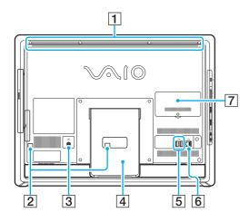
La zone entourant l'orifice d'aération (1) devient chaude lorsque l'ordinateur est sous tension. Attendez que l'ordinateur refroidisse avant de le toucher.
