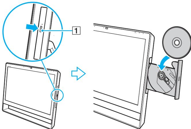
! Non esercitare pressione sul vassoio dell'unità. Assicurarsi di sostenere il vassoio dell'unità durante l'operazione di inserimento/rimozione del disco.
