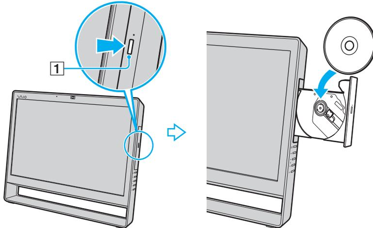
**!** No ejerza presión sobre la bandeja de la unidad. Asegúrese de sujetar la parte trasera de la bandeja de la unidad cuando coloque o quite un disco de la bandeja de la unidad.
