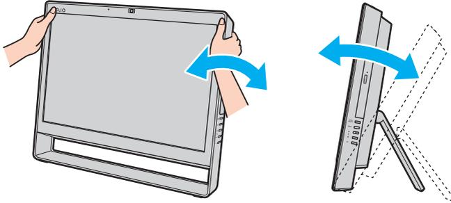
! Al ajustar el ángulo de visión, no ejerza una presión excesiva en el ordenador con el fin de evitar el riesgo de daño mecánico.
