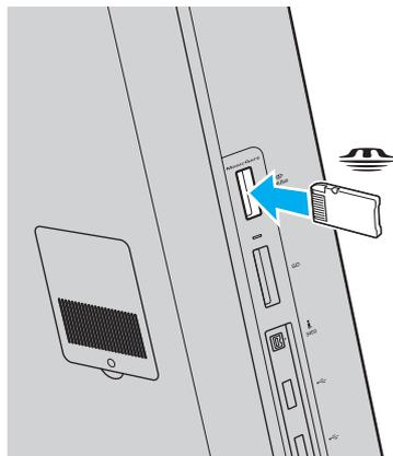
**!** Avant d'utiliser un support « Memory Stick Micro » (« M2 »), n'oubliez pas de l'insérer dans un adaptateur « M2 » Duo. Si vous insérez le support directement dans l'emplacement « Memory Stick Duo » sans l'adaptateur, vous risquez de ne pas pouvoir l'en retirer.
