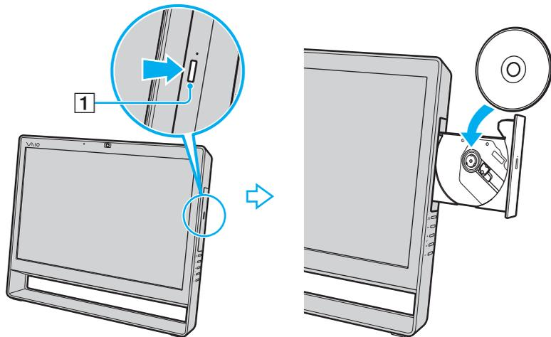
! Non esercitare pressione sul vassoio dell'unità. Assicurarsi di sostenere il vassoio dell'unità durante l'operazione di inserimento/rimozione di un disco.
