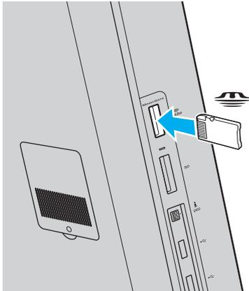
**!** Prima di utilizzare un supporto “Memory Stick Micro” (“M2”), accertarsi di inserirlo in un adattatore di formato “M2” Duo. Se si inserisce il supporto direttamente nello slot per “Memory Stick Duo” senza l’adattatore, potrebbe non essere possibile rimuoverlo dallo slot.
