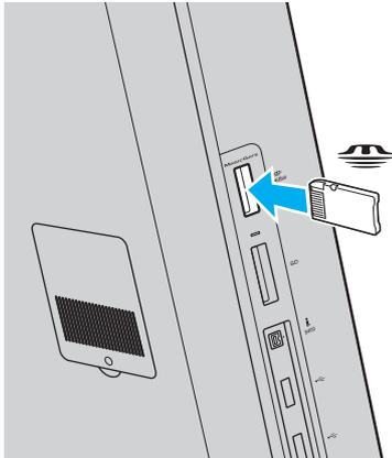
**!** Bevor Sie ein Memory Stick Micro (M2) verwenden, müssen Sie das Medium in einen M2-Duo-Adapter einsetzen. Falls Sie die Speichermedien ohne den Adapter direkt in den Memory Stick Duo-Steckplatz einsetzen, können Sie sie unter Umständen nicht wieder aus dem Steckplatz entnehmen.
