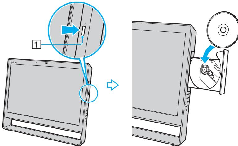
! Üben Sie keinen Druck auf die Laufwerksschublade aus. Halten Sie unbedingt die Rückseite der Schublade fest, wenn Sie Discs einlegen oder herausnehmen.
