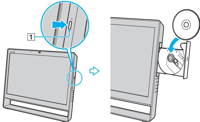
! Не прилагайте чрезмерных усилий к лотку дисковода. Устанавливая диск в лоток дисковода и извлекая его оттуда, необходимо поддерживать заднюю часть лотка.
