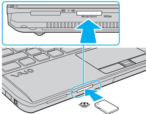
! Prima di utilizzare “Memory Stick Micro” (“M2”), accertarsi di inserirlo in un adattatore “M2” Duo. Se si inserisce il supporto direttamente nello slot “Memory Stick Duo” senza l’adattatore, potrebbe risultare impossibile rimuoverlo dallo slot.
