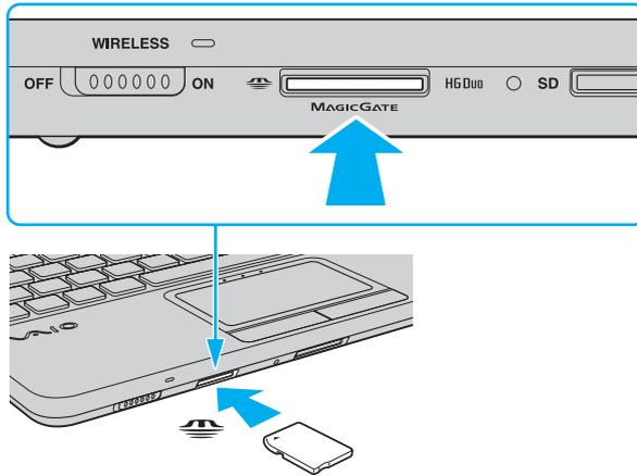
**!** Setzen Sie unbedingt Memory Stick Micro-Speichermedien (M2) in einen M2 Duo-Adapter ein. Falls Sie die Speichermedien ohne den Adapter direkt in den Memory Stick Duo-Steckplatz einsetzen, können Sie sie unter Umständen nicht wieder herausnehmen.
