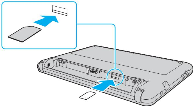
! Não toque no circuito impresso existente no cartão SIM. Segure no computador firmemente antes de inserir ou remover o cartão.
