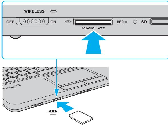
**!** Antes de utilizar um suporte “Memory Stick Micro” (“M2”), introduza-o num adaptador “M2” Duo. Se inserir o suporte directamente na ranhura para suportes “Memory Stick Duo” sem o adaptador, poderá não conseguir removê-lo da ranhura.
