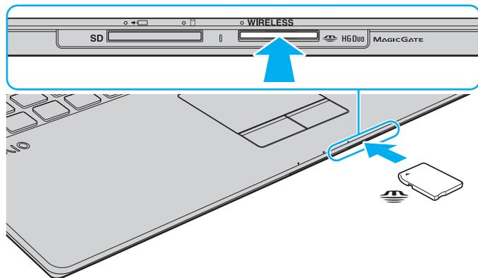
**!** Cuando la introduzca en la ranura, sujete la “Memory Stick” con la flecha apuntando en la dirección correcta. Para evitar daños en el ordenador o en el soporte, si la “Memory Stick” no entrara suavemente en la ranura, no emplee la fuerza.
