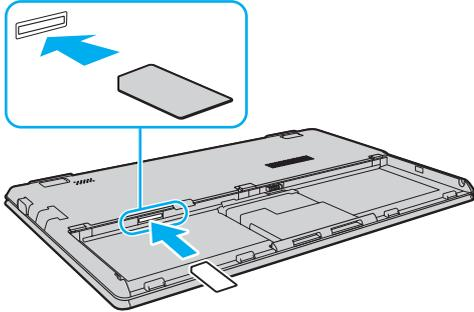
! No toque el circuito impreso de la tarjeta SIM. Sujete firmemente el ordenador antes de insertar o retirar la tarjeta.
