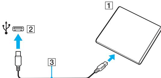
Подробные инструкции по подсоединению USB-кабеля к дисководу см. в руководстве дисковода оптических дисков.
