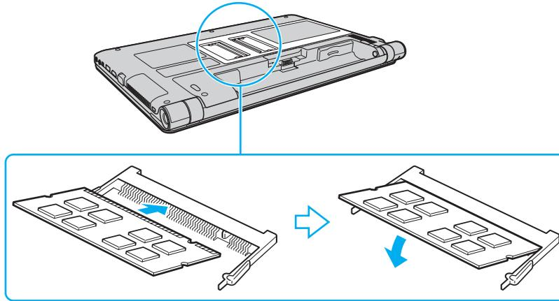
**!** Berühren Sie außer dem Speichermodul keine anderen Komponenten der Hauptplatine.
