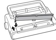
Vložte právý záves krytu do právhoho otvoru. Ľavy záves umiestnite na okraj otvoru a pomaly ho zasuňte tak, aby zapadol do ľavého otvoru.
