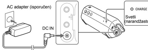
Punjenje započinje kada se uređaj poveže na AC utičnicu putem AC adaptera i indikator CHARGE zasvetli (narandžasto). Punjenje je dovršeno nakon približno 3 sata i indikator se isključuje.
