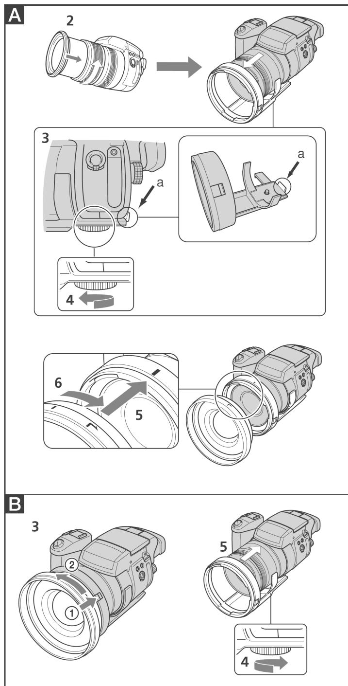
Koristite adapter objektiva kod učvršćenja konverzijskog objektiva (VCL-DEH08R/VCL-DEH17R) na Vaš digitalni fotoaparat.
