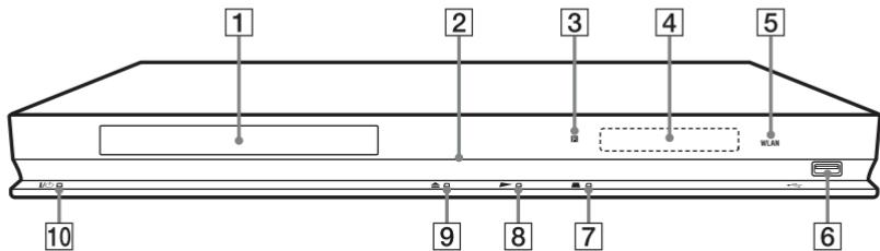
Tipka ► ima ispuštenje. Ispuštenje služi kao referentna tačka tokom upotrebe uređaja.
