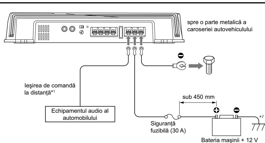
\*<sup>1</sup> Dacă la mașină folosiți fie echipamentul audio original, montat din fabrică, fie un altul care nu este dotat cu ieșire de comandă la distanță pentru amplificator, conectați terminalul de intrare pentru telecomandă (REMOTE) la mufă de alimentare pentru accesoriu.
