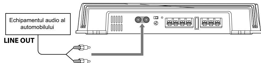
**B** Conexiune de intrare de linie (cu conexiune pentru boxe **3**).
