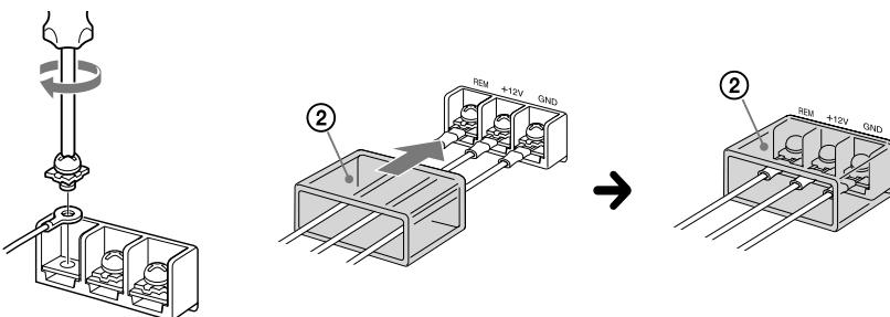
*Treceți firele prin capacul rectangular, conectați-le, apoi acoperiți conexiunile realizate cu respectivul capac.*
