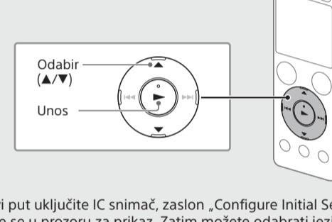
Kada prvi put uključite IC snimač, zaslon „Configure Initial Settings“ pojavljuje se u prozoru za prikaz. Zatim možete odabratiti jezik za prikaz, postaviti sat i uključiti/isključiti zvučni signal.
