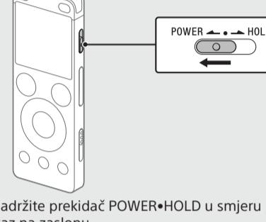
Pomaknite i zadržite prekidač POWER•HOLD u smjeru „POWER“ dok se ne pojavi prikaz na zaslonu.
