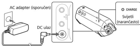
Punjenje započinje kad uređaj spojite na električnu utičnicu pomoću AC adaptera i počne svijetliti indikator CHARGE (narančasti). Punjenje završi za oko 3 sata i indikator se isključi.
