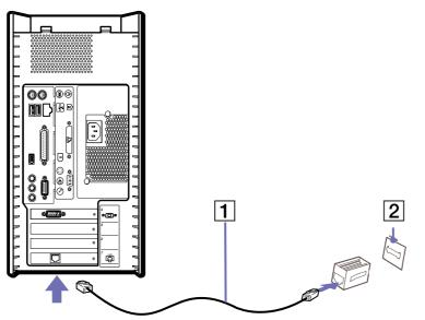
Mit Ihrem VAIO-Desktop wird ein länderspezifischer Telefonstecker mitgeliefert, mit dem Sie das Telefonkabel an der Telefonsteckdose anschließen können. Die Verwendung des mitgelieferten Steckers wird empfohlen, da die Verwendung eines anderen Telefonsteckers die Verbindungsqualität vermindern kann.
