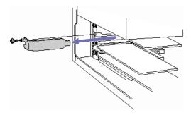
Installieren Sie die Hardwarekarte, indem Sie sie in den Steckplatz hineinstecken und anschließend mit der Schraube der Steckplatzabdeckung wie folgt befestigen (das Bild kein sich von der eigentlichen Konfigurierung unterscheiden):
