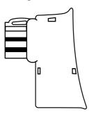
Deutschland: Nehmen Sie den Telefonsteckeradapter mit dem kleineren Kopf, der auf der Rückseite nicht mit einem weißen Dreieck versehen ist. Bringen Sie den Steckeradapter am Telefonkabel an:
