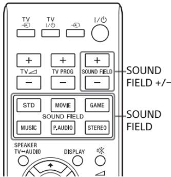
**Odaberite zvučno polje pritiskom na gumbе SOUND FIELD +/- ili na gumb SOUND FIELD zvučnog polja koje želite.**
