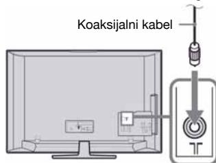
Spajanje antene/kabelskog sustava/videorekordera/
