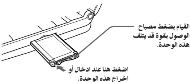
عندما تقوم بإدخال هذه الوحدة في جهاز الكمبيوتر أو عندما تقوم بإخراج هذه الوحدة من جهاز الكمبيوتر، يرجى التعامل معها كما موضح في الشكل التوضيحي. تبعاً لجهاز الكمبيوتر، تختلف كيفية إخراج هذه الوحدة.
