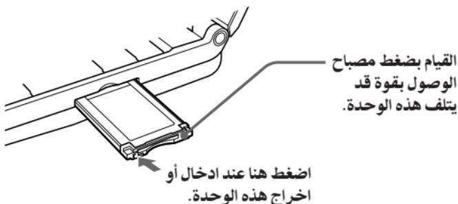
عندما تقوم بادخال هذه الوحدة في جهاز الكمبيوتر أو عندما تقوم بإخراج هذه الوحدة من جهاز الكمبيوتر، يرجى التعامل معها كما موضح في الشكل التوضيحي. تبعاً لجهاز الكمبيوتر، تختلف كيفية إخراج هذه الوحدة.
