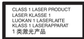
Este aparelho está classificado como equipamento CLASS 1 LASER. A indicação CLASS 1 LASER PRODUCT está localizada no exterior da parte traseira.
