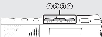
Kada prvi put uključite napajanje ili dok sat još nije podešen, na zaslonu će se prikazati „Setting Date&Time“ i tada možete podešiti sat.
