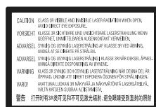
Acest marcaj este amplasat pe carcasa de protecție a laserului în interiorul incintei.
