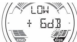
Ponovite korake 2 i 3 za podešavanje krivulje. Za povratak na tvorničku postavku krivulje ekvilizatora, pritisnite tipku **SELECT** prije dovršenja podešavanja.
