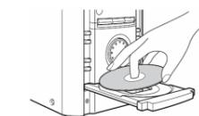
Za zatvaranje uložnice diska, pritisnite ▲ (otvaranje/zatvaranje) [8] na uređaju. Ne zatvarajte uložnicu silom, kako ne bi oštetili uređaj.
