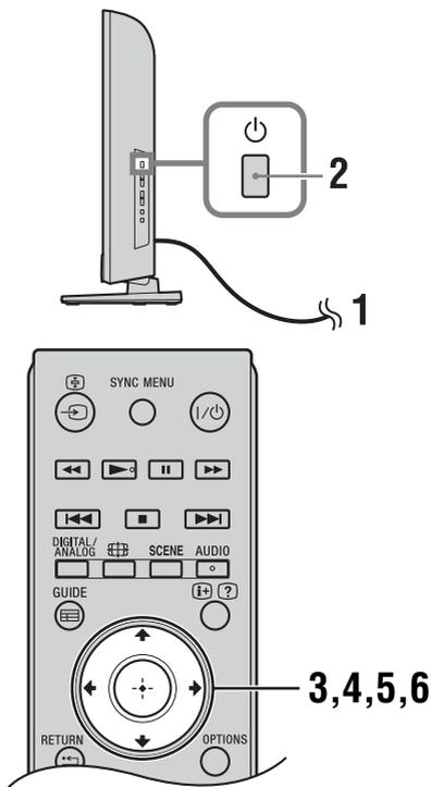
**1** Priključite televizor u zidnu utičnicu (220-240 V AC, 50 Hz).
