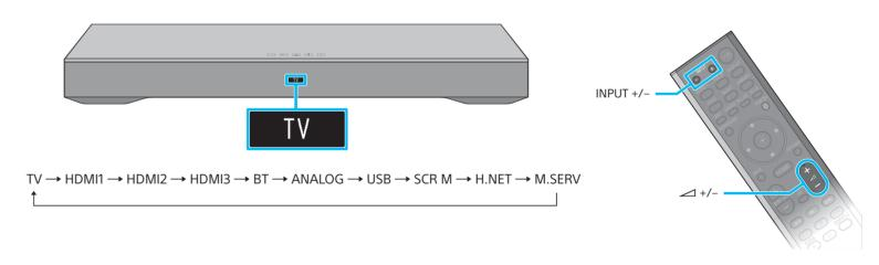
Prima INPUT +/- repetidamente até o dispositivo pretendido ser apresentado no visor do painel frontal. Em seguida, prima 🖂 +/- repetidamente para ajustar o volume.
