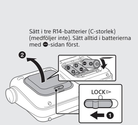
Skyddet till batterifacket måste vara helt stängt för att radion ska vara vattentät. Mer information finns i "Vattentät funktion (läs innan du använder radion)".
