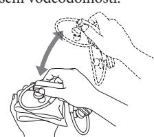
Gumové těsnění používané na krytu konektoru USB může vlivem dlouhodobého používání nebo používání v určitých prostředích prasknout nebo se zdeformovat. Doporučujeme vám, abyste pro zajištění voděodolnosti pravidelně kontrolovali stav tohoto těsnění a krytu konektoru USB.
