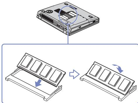
! Achten Sie darauf, dass Sie außer den Speichermodulen keine anderen Komponenten auf der Hauptplatine berühren.
