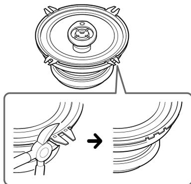
Ovaj zvučnik je moguće ugraditi u većinu automobila ako im uklonite nosače za ugradnju. **Koristite kliješta ili škare za lim kako biste odrezali ili odlomili nosače do ruba okvira zvučnika.**
