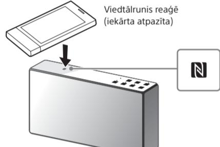
Lai izveidotu savienojumu, izpildiet ekrānā redzamos norādījumus. Tiekliņi BLUETOOTH savienojums ir izveidots, iekārtas indikators (BLUETOOTH) paliek degam.
