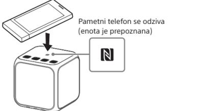
Upošteвайте navodila na zaslonu, da vzpostavite povezavo. Ko je povezava BLUETOOTH vzpostavljena, indikator **(BLUETOOTH)** na enoti sveti neprekinjeno. Če želite povezavo prekiniti, se s pametnim telefonom znova dotaknite enote.
