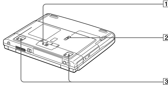
**1** Abdeckung für den Anschluß des Port-Replikators
