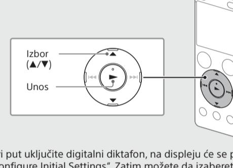
Kada prvi put uključite digitalni diktafon, na displayu će se prikazati ekran „Configure Initial Settings“. Zatim možete da izaberete jezik displeja, podesite sat i uključite/isključite zvučni signal.
