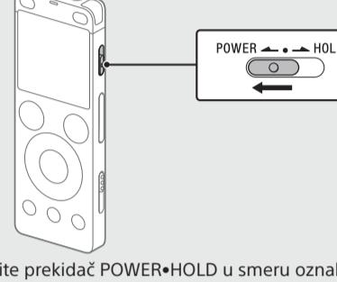
Povucite i držite prekidač POWER•HOLD u smeru oznake „POWER“ dok se ne prikaže display.
