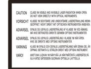
Ova nalepnica je smeštena na zaštitnom poklopcu lasera unutar kućišta.
