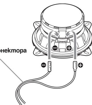
В зависимост от модела на автомобила, използвайте специален конектор (не е приложен в комплекта). Вижте монтажния пример за повече подробности.
