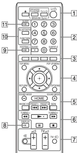
Die Zahlentaste 5 sowie die Tasten AUDIO,  $\blacktriangleleft$  + und  $\blacktriangleright$  verfügen über einen fühlbaren Punkt. Verwenden Sie den fühlbaren Punkt als Anhaltspunkt beim Bedienen mit der Fernbedienung.
