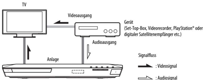
Wählen Sie je nach Buchsenart der Komponente eine der folgenden Anschlussmethoden für das Gerät.
