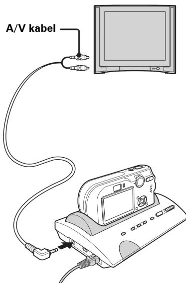
Ako vaš TV prijemnik ima stereo ulaze, spojite audio utikač (crni) A/V kabela na lijevi audio priključak.
