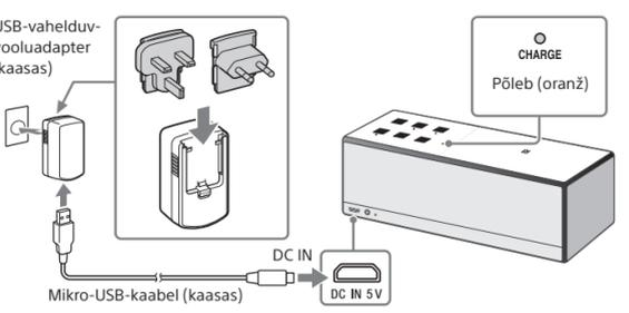
Kui väljalülitatud seade ühendatakse kaasas oleva USB-vahelduvvoolu-adapteri abil vahelduvvoolukontaktiga, algab laadimine ja näidik CHARGE süttib oranžilt. Laadimine lõpeb ligikaudu viie tunni pärast ja näidik kustub.
