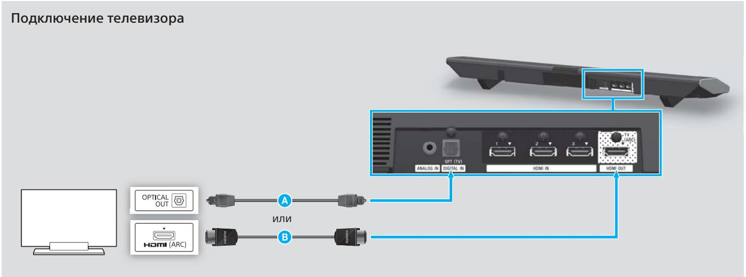
Если телевизор, который следует подключить, не оснащен оптическим разъемом аудиовыхода, подсоедините кабель HDMI (не входит в комплект, следует использовать высокоскоростной тип) к входному разъему HDMI с пометкой ARC. Если к входному разъему HDMI, помеченному как ARC, подключено другое устройство, отключите это устройство и подключите данную панель динамиков.
