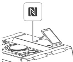
Führen Sie die Verbindungsherstellung anhand der auf dem Smartphone angezeigten Anweisungen durch. Nachdem die BLUETOOTH-Verbindung hergestellt wurde, wird der Name des BLUETOOTH-Geräts im Bedienfeld-Display eingeblendet.
