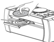
Druk nogmaals op ▲ op het apparaat om de disclade te sluiten. Druk niet krachtig tegen de disclade om deze te sluiten, omdat dit een defect kan veroorzaken.
