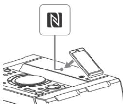
Voltooide de verbinding door de instructies die op de smartphone worden weergegeven te volgen. Zodra de BLUETOOTH-verbinding tot stand is gekomen, wordt de naam van het BLUETOOTH-apparaat op het displaypaneel weergegeven.
