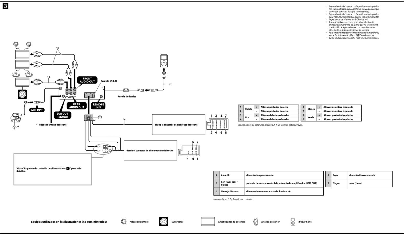
\*1 Dependiendo del tipo de coche, utilice un adaptador (no suministrado) si el conector de antena no encaja.
