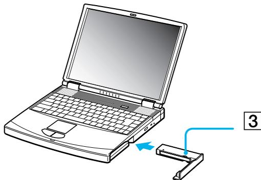
🔧 Se si collegano due batterie, è possibile rimuoverne una senza spegnere il computer. Rimuovendo una batteria, assicurarsi che l'indicatore dell'altra batteria sia acceso. Se l'indicatore della batteria che si sta per rimuovere è acceso, fare clic con il pulsante destro del mouse sulla barra delle applicazioni e selezionare l'opzione **Cambia batteria in uso**.
