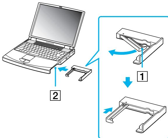
Per rimuovere la protezione dello slot modulare, procedere come segue:
