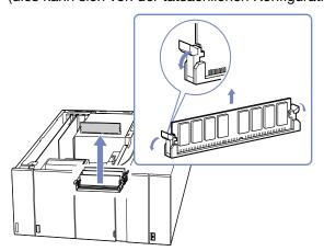
6 Nehmen Sie das neue Speichermodul beim Herausnehmen aus der antistatischen Verpackung nur an den Kanten.
